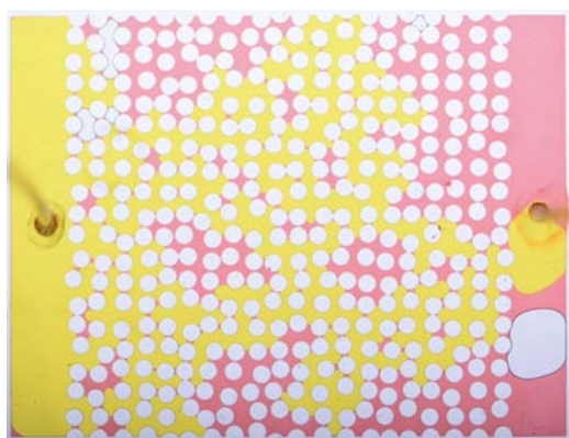
Figure 1: Drainage par de l'eau (en jaune) d'un milieu initialement sature par de l'huile (en rouge)
